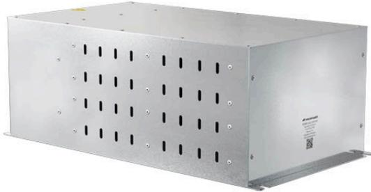
Тормозной резистор PROMPOWER PDBR-30K-18R-25-T2, мощность 30 кВт, 18 Ом, ПВ 25% (120 с), IP 54, способ подключения: клеммная колодка, корпус из оцинкованной стали, габарит M12 (Ширина 200 мм; Высота 125 мм; Длина 460 мм) масса 14 кг. Датчик температуры РТС
