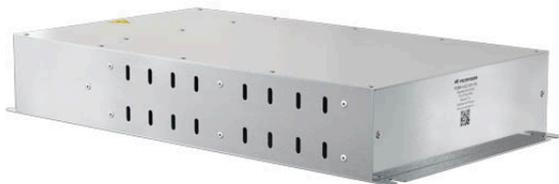
Тормозной резистор PROMPOWER PDBR-30K-18R-10-T2, мощность 30 кВт, 18 Ом, ПВ 10% (120 с), IP 54, способ подключения: клеммная колодка, корпус из оцинкованной стали, габарит М6 (Ширина 200 мм; Высота 70 мм; Длина 460 мм) масса 9 кг. Датчик температуры РТС
