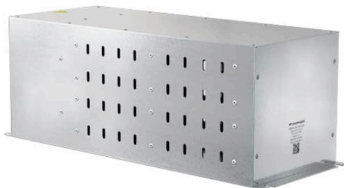
Тормозной резистор PROMPOWER PDBR-18K5-30R-25-T2, мощность 18,5 кВт, 30 Ом, ПВ 25% (120 с), IP 54, способ подключения: клеммная колодка, корпус из оцинкованной стали, габарит М8 (Ширина 140 мм; Высота 125 мм; Длина 460 мм) масса 11 кг. Датчик температуры РТС
