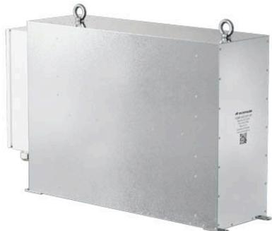
Тормозной резистор PROMPOWER PDBR-160K-4R-25, мощность 160 кВт, 4 Ом, ПВ 25% (120 с), IP 54, способ подключения: клеммная колодка, корпус из оцинкованной стали, габарит Д94 (Ширина 240 мм; Высота 630 мм; Длина 835 мм) масса 60 кг.
