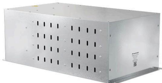
Тормозной резистор PROMPOWER PDBR-110K-8R-5, мощность 110 кВт, 8 Ом, ПВ 5% (120 с), IP 54, способ подключения: клеммная колодка, корпус из оцинкованной стали, габарит M12 (Ширина 200 мм; Высота 125 мм; Длина 460 мм) масса 14 кг.
